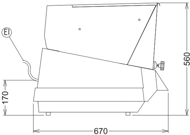
EI = Conexión eléctrica (energía)
